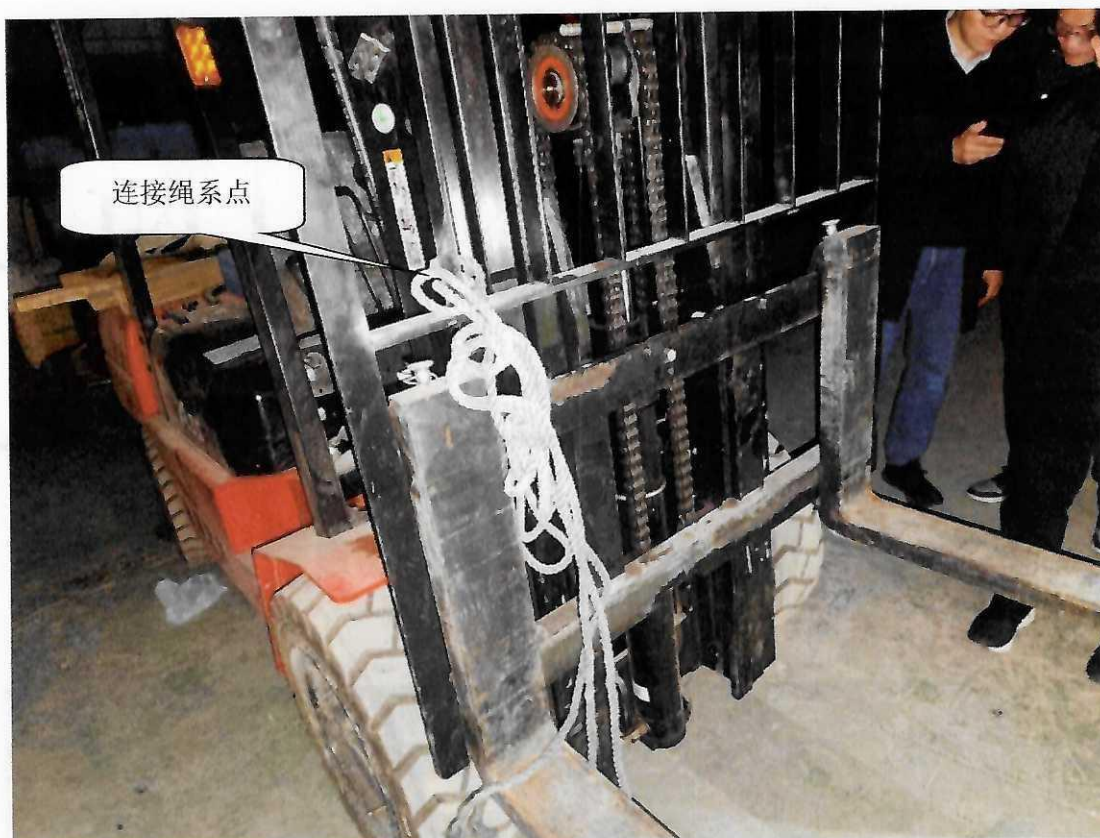
图 7 连接绳系于叉车门架一侧
