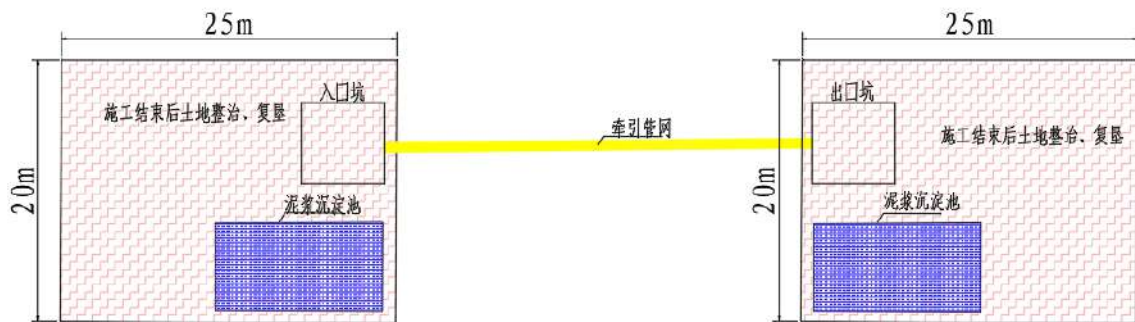
图 2-5 穿越工程施工防护图
