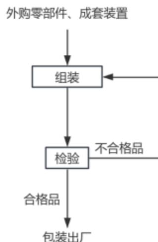
图 2-1 项目激光增材生产工艺流程及产污环节图
