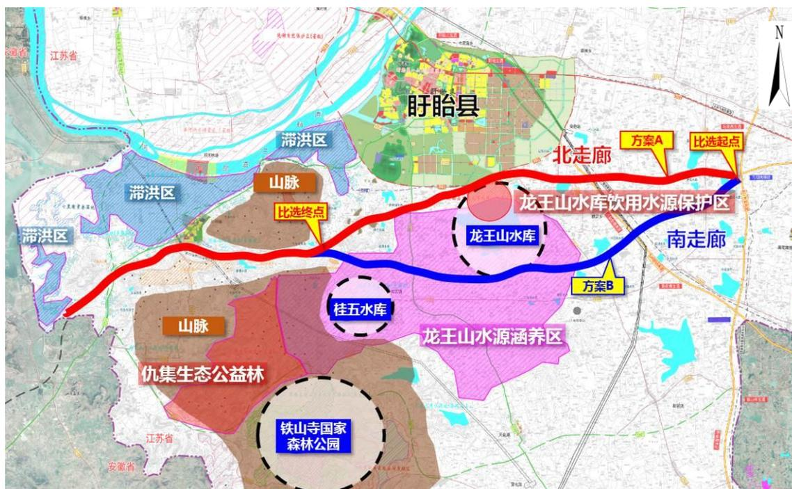
图 1.8-1 起点至桂五水库段路线方案比选示意图
