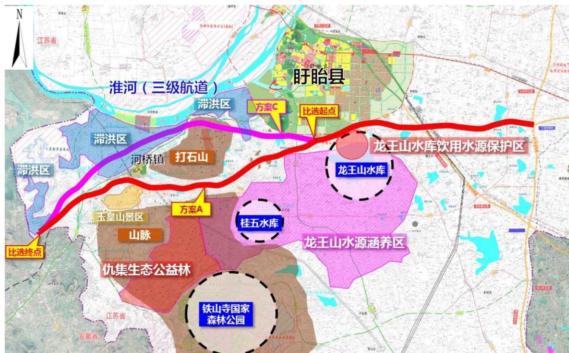
图 1.8-2 桂五水库至苏皖省界段线方案比选示意图
