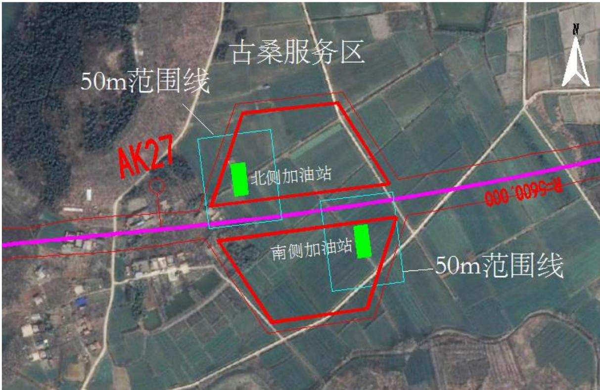
图 4.2-1 拟新建的古桑服务区加油站卫生防护距离范围图
